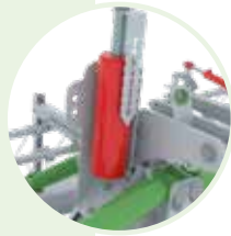
Variflex : modulation continue de la pression des dents par réglage hydraulique à l'aide de multiples vérins de compensation et d'un ou deux vérin(s) central(-aux) avec repère gradué.
