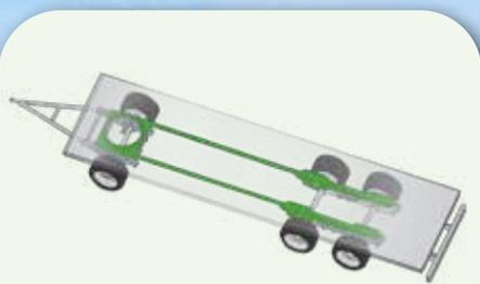
El bastidor de todos los remolques plataformas JOSKIN está fabricado con una **estructura tubular de acero de alto límite elástico** para mejorar la resistencia a la torsión.
