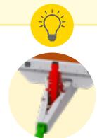
**Soporte hidráulico central** retráctil dentro de la lanza con patín ancho, de serie en los WAGO semi-portados.
