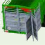
Hintere Sicherheitsgitter ermöglichen eine Luftzirkulation (ideal bei längerem Stillstand für Transporte bei großer Hitze).
