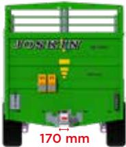
**Schmale Deichsel** für wendiges Manövrieren. Deichselaufhängung mit **Federung** und **verstellbare Gleitschiene** (wartungsfreies Ertalon).
