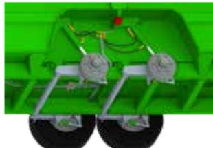
**Hydro-Tandem und stoßdämpfende Federung** durch Stickstoffkugel + Absturzsicherung.
