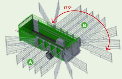
Um 173° schwenkbare Schienengitter, erhältlich in den Längen 3,5 m (A) oder 4,5 m (B).
