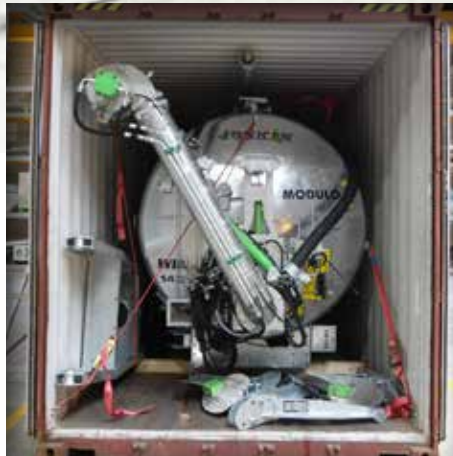
1 Modulo2 Güllefass 14 000 l in einem 40 Fuß HC-Container
