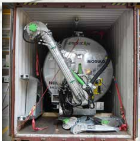
1x mengmesttank van 14 000 l in een 40 ft HC container
