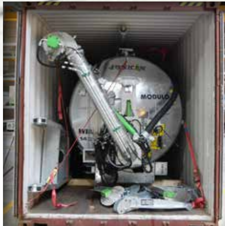
1 Modulo2 Güllefass 14 000 l in einem 40 Fuß HC-Container
