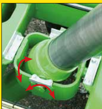
Dubbel schommelframe waarin de cilinder geplaatst wordt
