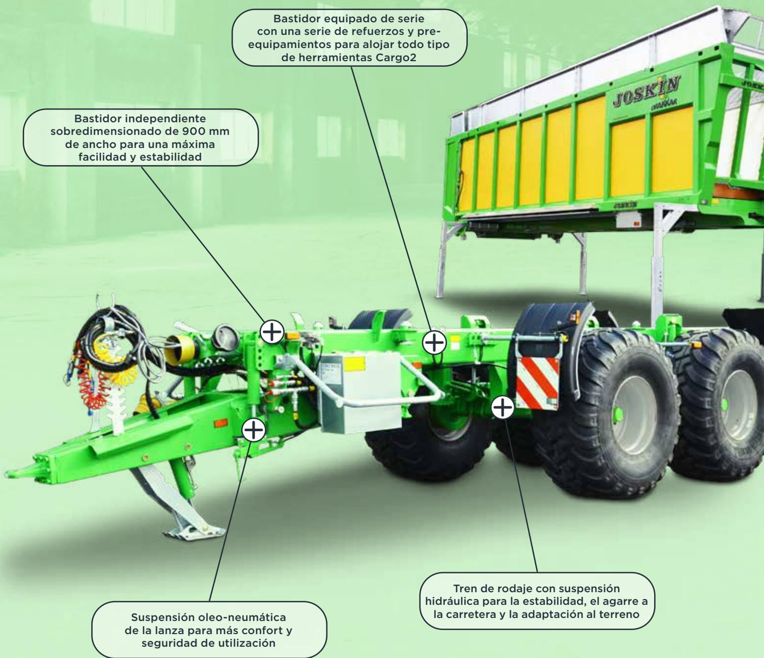
Bastidor equipado de serie con una serie de refuerzos y pre-equipamientos para alojar todo tipo de herramientas Cargo2
