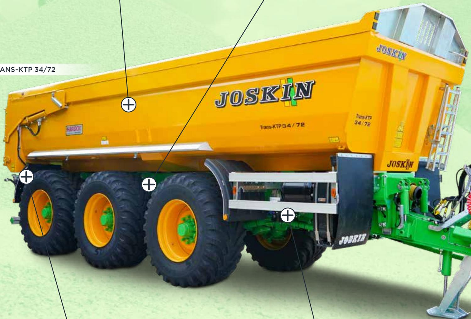
Bisagra de vuelco extra ancha para una estabilidad y una seguridad máxima de ejecución
