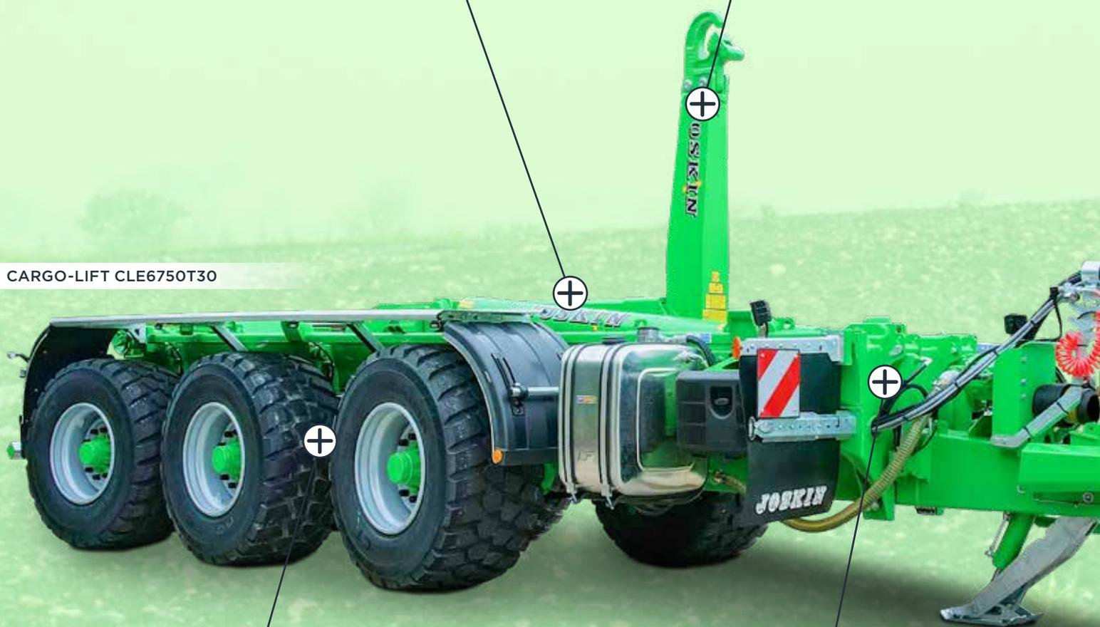
Tren de rodaje JOSKIN (láminas parabólicas o suspensión hidráulica en función del modelo)
