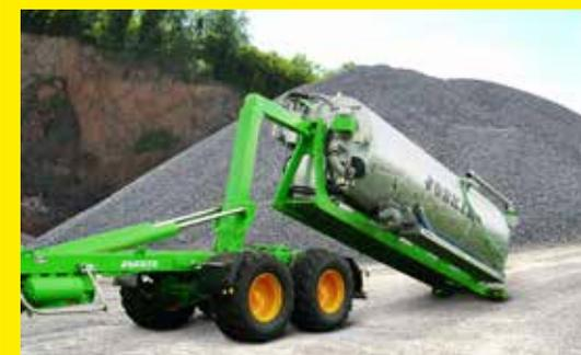
Tonnes à eau Cargo-Lift avec système d'accroche container.
