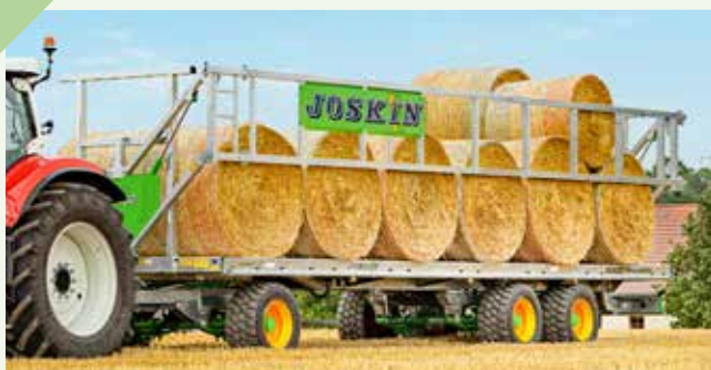
WAGO trainé (9 versions peintes ou galvanisées) Charge utile : 14 à 21 t | Longueur : 8, 10, 11,1 ou 11,7 m 2 ou 3 essieux
