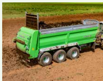
Ferti-SPACE2 HORIZON (9 versions) Volume : 12,32 à 30,22 m 3 Simple, double ou triple essieu
