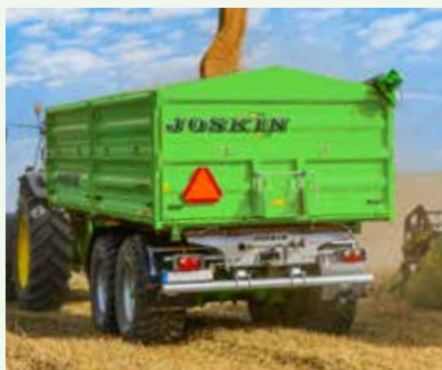
Delta-CAP (11 versions) Volume de caisse 1 : 10,89 à 19,36 m 3 Charge utile : 8 à 14 t Simple ou double essieu
