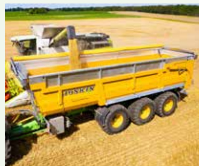
Trans-SPACE (14 versions) Volume de caisse 1 : 18,1 à 30,92 m 3 Charge utile : 18 à 26 t Double ou triple essieu
