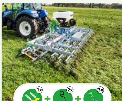
Scariflex R6D2S3 (2 versions) Largeur de travail : 6 ou 7,2 m Repliage hydraulique
