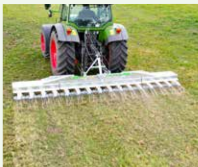
BF (10 versions) Largeur de travail : 2,4 à 5,4 m Repliage manuel ou hydraulique
