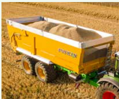
Trans-CAP (11 versions) Volume de caisse 1 : 10,2 à 21,9 m 3 Charge utile : 10 à 18 t Simple ou double essieu
