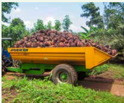
Trans-PALM (9 versions) Volume de caisse 1 : 6,6 à 16,8 m 3 Charge utile : 10 à 16 t Simple ou double essieu
