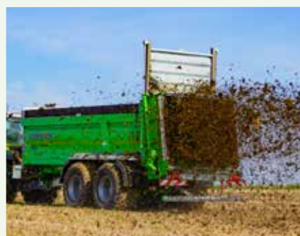
Ferti-SPACE2 (9 versions) Volume : 12,32 à 30,22 m 3 Simple, double ou triple essieu
