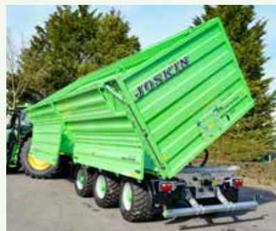
Delta-SPACE (2 versions) Volume de caisse 1 : 28,92 à 32,54 m 3 Charge utile : 24 t Triple essieu
