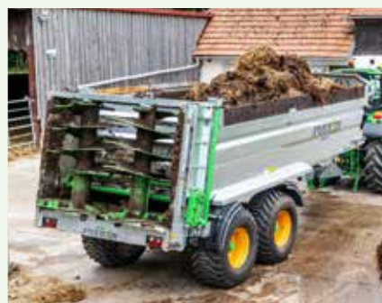
Ferti-CAP (4 versions) Volume : 6,91 à 13,97 m 3 Simple ou double essieu
