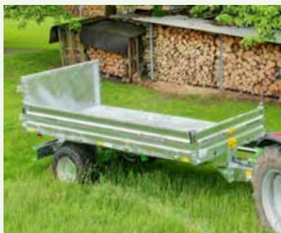
Trans-EX (8 versions) Volume de caisse 1 : 1,9 à 4,5 m 3 Charge utile : 3 à 9 t Simple ou double essieu
