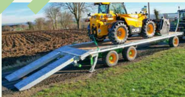
WAGO-Loader trainé (3 versions galvanisées) Charge utile : 14 ou 21 t | Longueur : 8 ou 9,9 m 2 ou 3 essieux Type de rampes : manuelles ou hydrauliques
