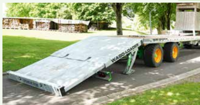
WAGO-Loader semi-porté (4 versions galvanisées) Charge utile : 14 ou 24 t | Longueur : 8, 9,9 ou 10 m Double ou triple essieu Type de rampe(s) : manuelles, hydrauliques ou télescopique
