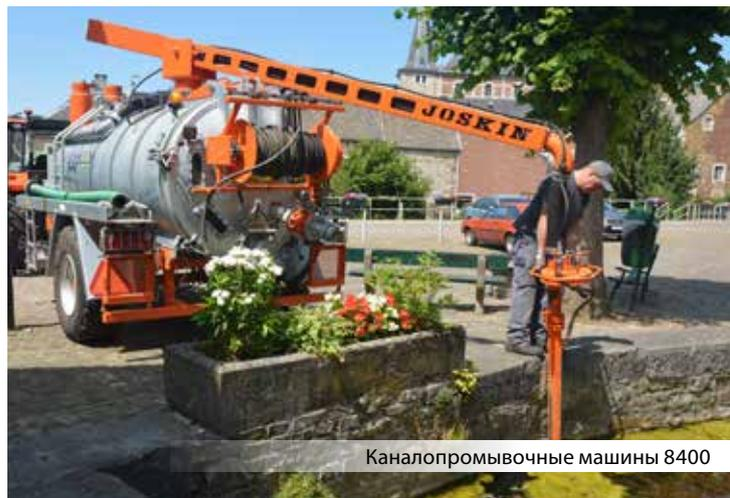
Каналопромывочные машины 8400
