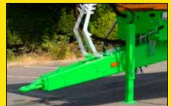
Опора с гидроприводом
