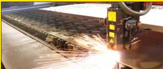
Платформа лазерной резки
