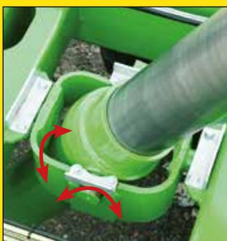
Двойная подвижная рама, на которую установлен гидроцилиндр
