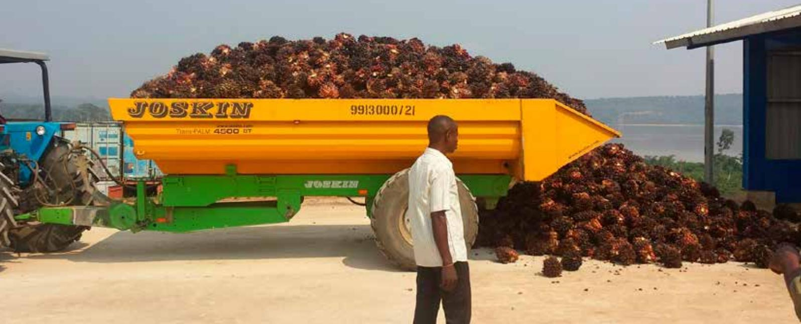
Эти машины предназначены для перевозок специфической продукции - плодов масличной пальмы. Прицеп, взявший за свою основу концепцию Trans-Car, является простым, прочным и способным передвигаться по плохим дорогам. Дышло с рессорной подвеской обеспечивает плавность и защищает водителя от возможных толчков. В опции предлагается усиленная ось.
