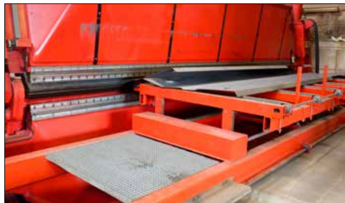
Cyfrowa prasa krawędziowa o sile nacisku 600 ton
