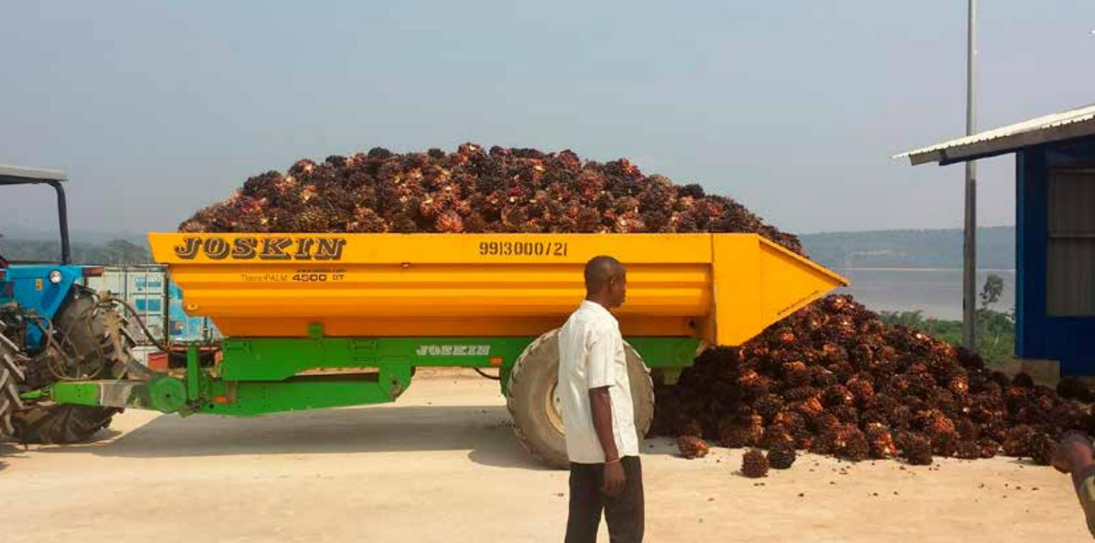
JOSKIN a conçu une benne spécialement adaptée à la récolte de régimes de palmes brutes. Basée sur le succès de la Trans-Cap, cette benne se veut simple, solide et capable de résister à tous types de chemins. Le timon ressort garantit une grande souplesse et protège le chauffeur des chocs occasionnés. En option, il est possible d'avoir un essieu renforcé.
