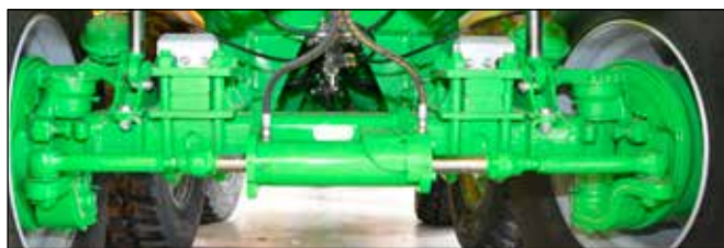
Osć skrętna wymuszająca (w 100 % skrętna)
