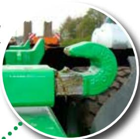
Granallado antes de pintura, laca de imprimación Ester Epoxy (2 K) y laca de acabado
