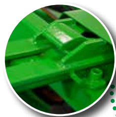
Hydraulische Verriegelung des Containers
