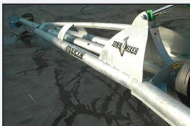
La hélice está alimentada por un eje de transmisión de Ø 115 mm, revestida por un tubo de gran espesor. El mismo aloja 5 puntos (cojinetes, rodamientos de bronce, tubería semifija de bronce, ...) y está completamente sumergido en baño de aceite. Esta característica evita los problemas de desgaste prematuro y de sobrecalentamiento. Además, el Jumbomixer se beneficia de una excelente protección que aumenta su vida útil.
