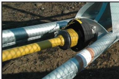
El Jumbomixer está equipado en estándar con un cardán reforzado en tubo dentado con un árbol 1 3/4" provisto de una seguridad de bulón. Requiere una potencia mínima de 100 CV para funcionar. Su longitud total es de 7 m y su peso es de 450 kg.
