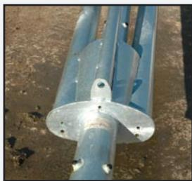
Notons que les roulements de l'hélice sont intégrés dans un "kit complet". Ce kit monobloc fait office d'intermédiaire entre l'hélice et l'axe de transmission. Ainsi, en cas d'usure des roulements, ce kit est facilement remplaçable et empêche la substitution complète de tout l'axe de transmission.
