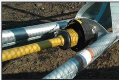
Le Jumbomixer est équipé, en standard, d'un cardan renforcé en tube étoilé avec un arbre 1 3/4" muni d'une sécurité à boulon. Il nécessite une puissance minimale de 100 CV pour fonctionner. Sa longueur totale est de 7 m et son poids est de 450 kg.
