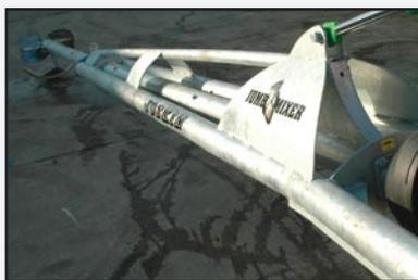
L'hélice est alimentée par un axe de transmission de Ø 115 mm, enveloppé par un tuyau d'une importante épaisseur. Cet axe, logé sur 5 points (paliers, roulements en bronze, buselures en bronze, ...), est complètement immergé dans un bain d'huile. Cette caractéristique majeure permet d'éviter tout problème d'usure prématurée et de surchauffe. Le Jumbomixer bénéficie ainsi d'une excellente protection et sa durée de vie en est accrue.
