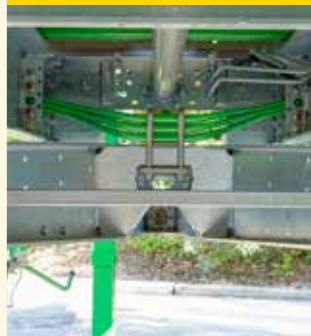
Deichselfederung mit parabelförmigen Blattfedern
